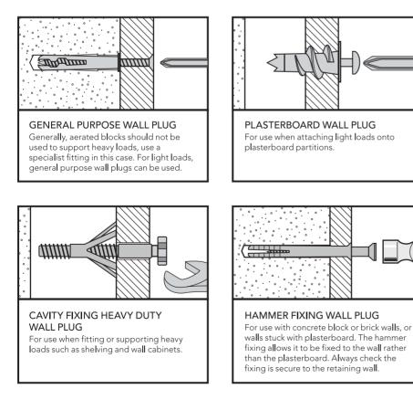
CAVITY FIXING WALL PLUG
